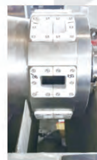
卧式螺旋沉降离心机耐磨结构
