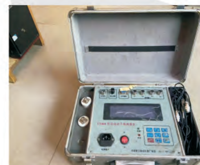
离心机整体现场动平衡系统
